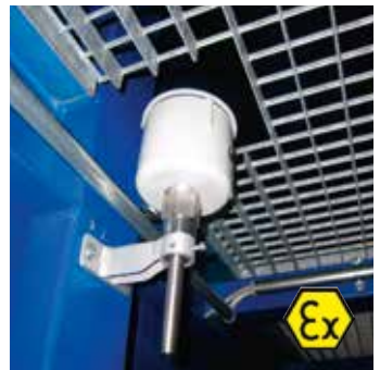
Termostato per la rilevazione e regolazione della temperatura in ambienti con pericolo di esplosione o con atmosfera fortemente aggressiva. Tipo di protezione: II 2 GD Ex d IIC T6-Ex tD A21. Grado di protezione: IP66/67.
