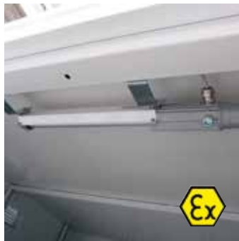
Armatura illuminante per lampade fluorescenti in alluminio marino con reattore elettronico. Tipo di protezione: II 2GD Ex d IIB / Ex d IIC / Ex e II / Ex tD A21. Grado di protezione: IP66.
